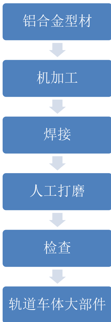
图 4.1 产品生产流程图
